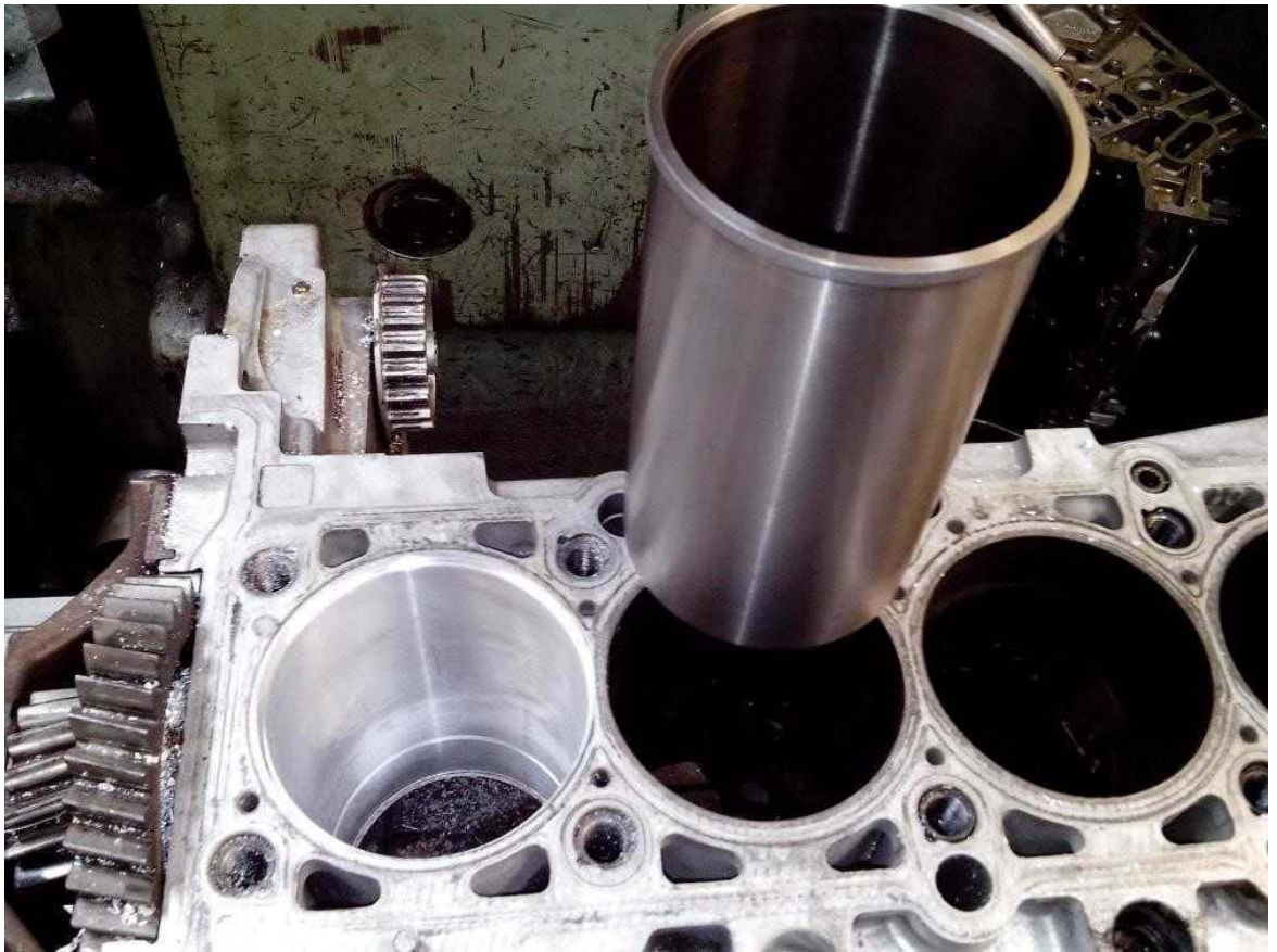
1-сурет – Автокөлік қозғалтқышына қойылатын жұқа қабырғалы гильза
